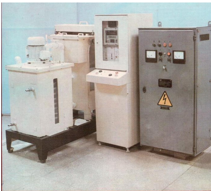
Рис. 6.10 – Установа регенерації кольорових металів з промивних вод
