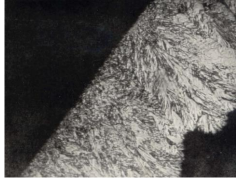
Рис. 4.16 – Мікроструктура осадженої міді (поперечний переріз) міді, збільшено \times 120
