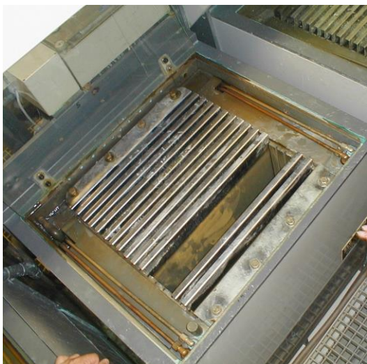
Рис. 6.8 – Вигляд установки відновлення водних розчинів (вид на катодні пластини)
