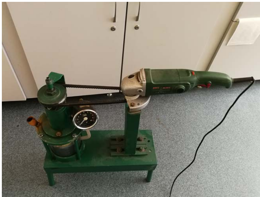
Рисунок 6.3 – Установка для проведення гідродинамічної кавітації у процесі отримання адсорбенту
