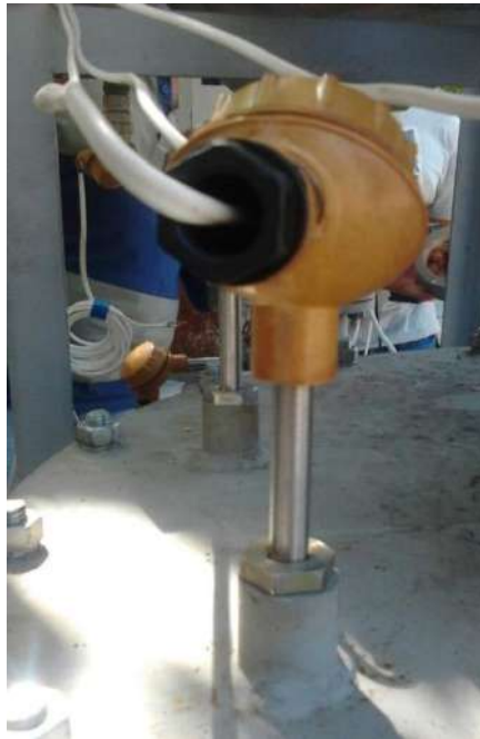
Рисунок М.1- Зовнішній вигляд термопар типу ТХК
