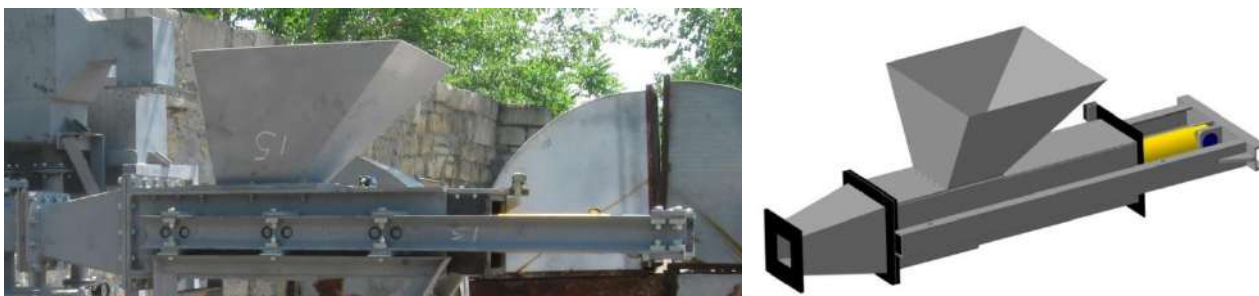
Рисунок 4.7 – Комп'ютерне 3D зображення та фото плунжерної системи
