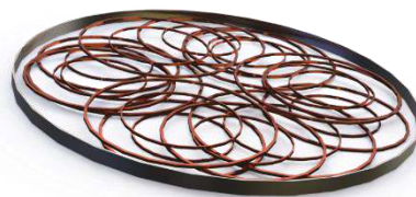
Рисунок 4.71 - Елемент моделювання піролізного реактора з об'ємною решіткою утвореною бортовими кільцями і металокордом автошин під дією статичного навантаження
