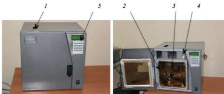
Рисунок 2.26 – Хроматограф NeoChrom class SX: 1 - інжектор; 2 – термостат; 3- колонка; 4 - блок детектору; 5 - панель управління
