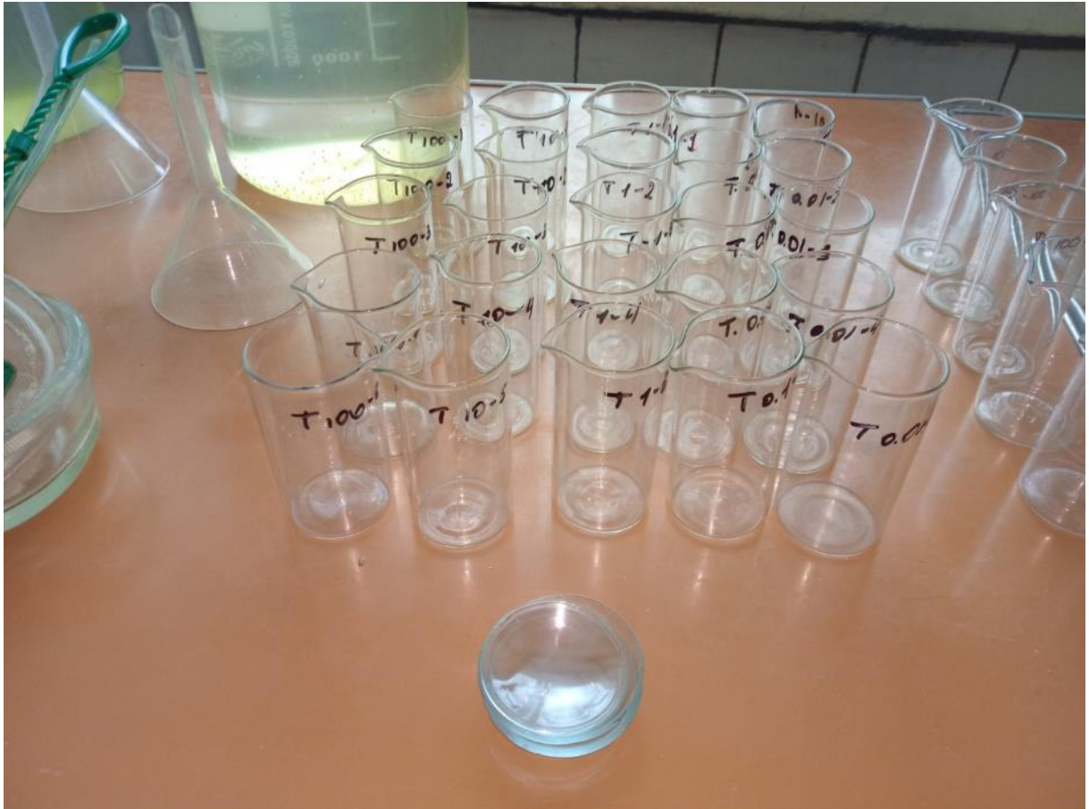
Рис.2.3. Підготовка досліді біотестування токсичності мийних засобів на тест-об'єкті Daphnia magna
