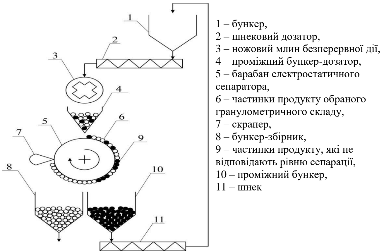
Рисунок 8 – Блок-схема застосування електростатичної сепарації
