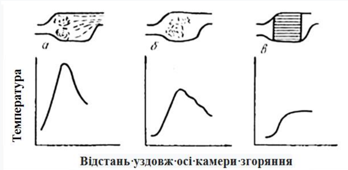
Рис. 3.17. Зміна температури за довжиною камери, де а – звичайна камера; б – камера зі ступеневим підведенням тепла; в – каталітична камера
