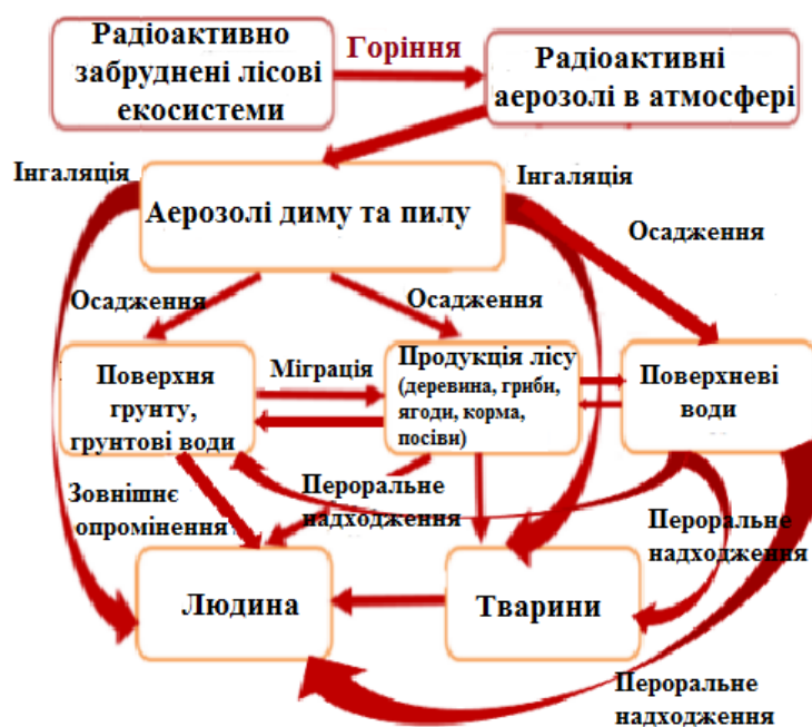
Рис. 1.8 – Схематичне зображення міграції техногенних радіонуклідів внаслідок лісових пожеж [45].
