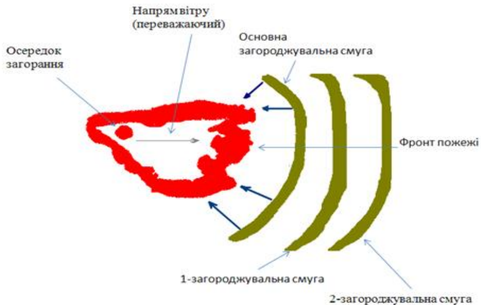
Рис. 7.3 – Схема гасіння лісової пожежі з використанням солей ПГМГ
