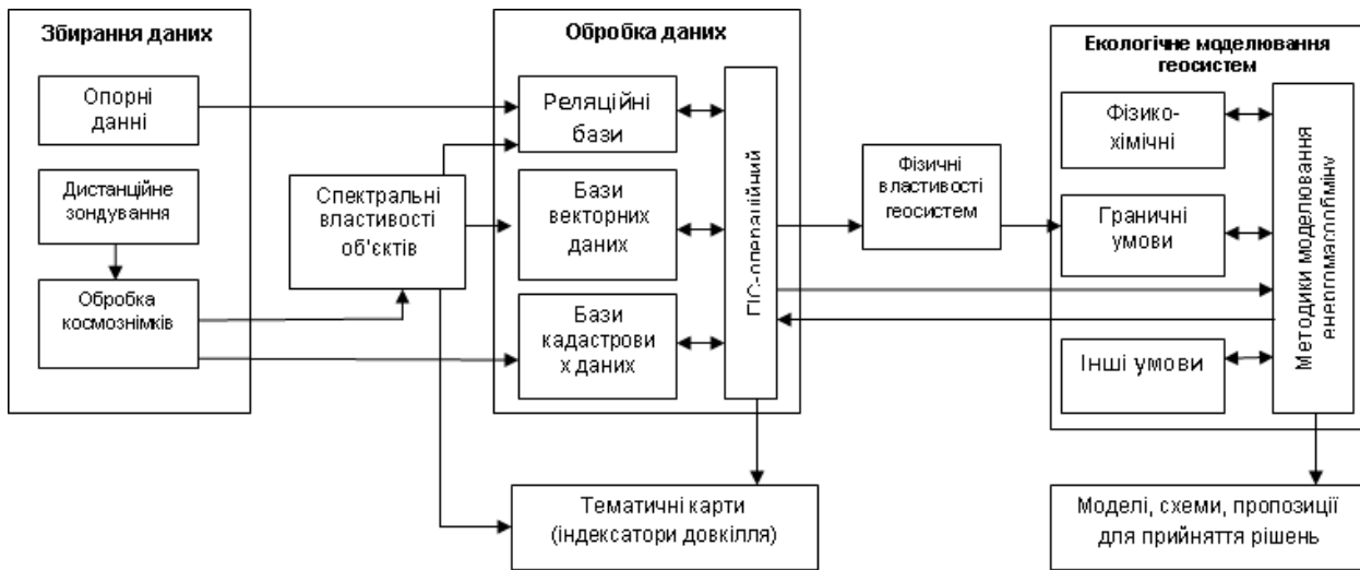
Рис. 1.4 - Структура використання даних дистанційного зондування Землі для оцінки навколишнього середовища з космосу
