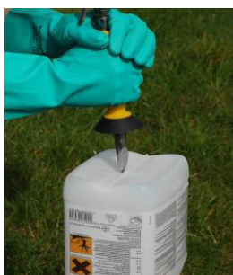
Рисунок 5.11а –Зображення обладнання та процесу проколювання пластикової тари з з-під пестицидів
