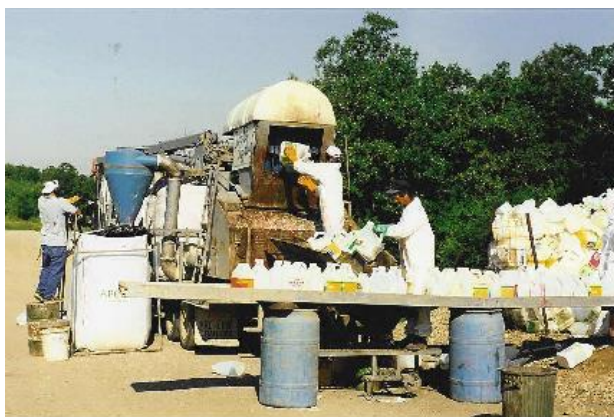
Рисунок 5.12– Зображення центру збору тари з-під пестицидів у Чилі та процесу подрібнення промитої пластикової тари у мобільному шредері
