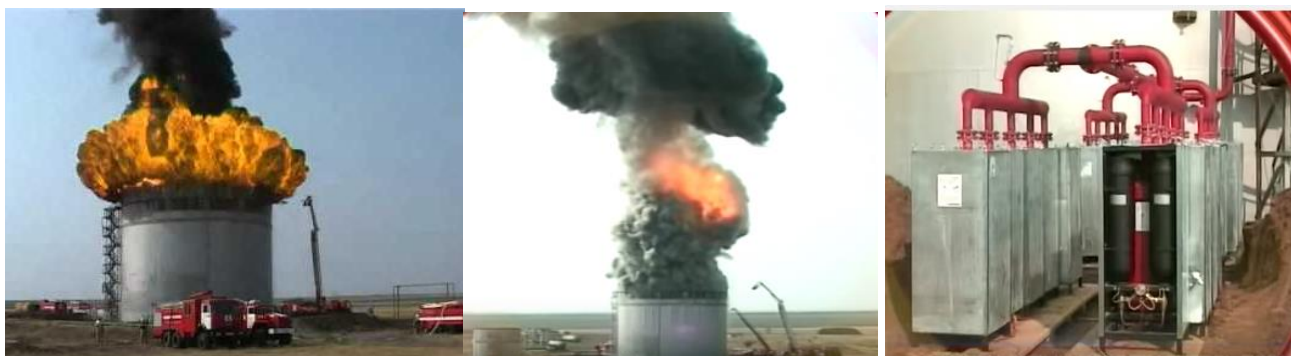
Рисунок 1.4 – Стаціонарна установка «ViZone 5000»
