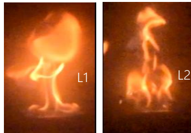
Рисунок 4.38– P_{yx} = 195 Па: Аерозоль = 4,8 г/м 3 ; N_2 = 5,6\% ; L1 = 66 мм; L2 = 106 мм; \tau = 35 мс; Q = 18 кВт
