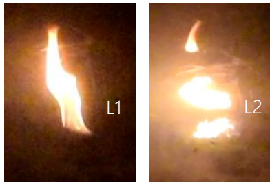
Рисунок 4.28 – P_{yx} = 180 Па: N_2 = 26,4\% ; L1 = 14 мм; L2 = 42 мм; \tau = 15 мс; Q = 4 кВт
