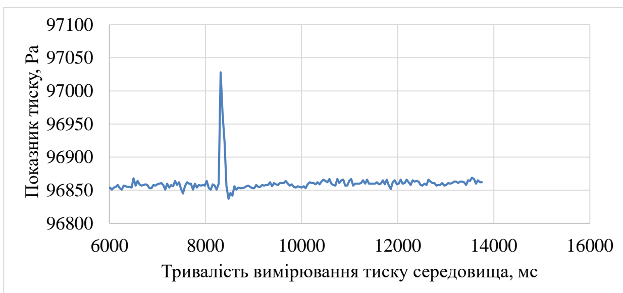
Рисунок 4.24 – Ударна хвиля з надлишковим тиском 180 Па
