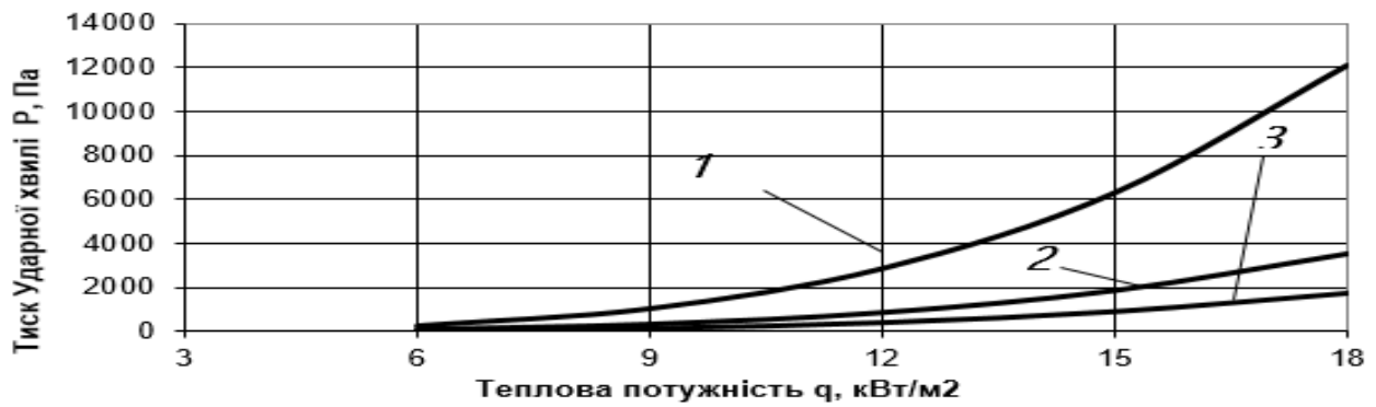
Рисунок – 4.9 Вплив потужності теплового потоку на величину тиску ударної хвилі: 1 – при \Gamma(\text{CO}_2) = 3,5\% ; A = 2,9 \text{ г/м}^3 ; 2 – при \Gamma(\text{CO}_2) = 9,75\% ; A = 7,45 \text{ г/м}^3 ; 3 – при \Gamma(\text{CO}_2) = 16\% ; A = 12 \text{ г/м}^3
