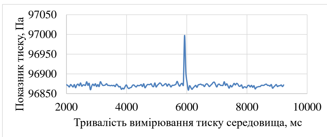
Рисунок 4.23 – Ударна хвиля з надлишковим тиском 125 Па
