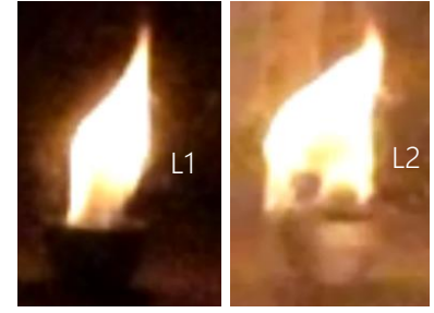
Рисунок 4.17 – P_{yx} = 316 Па L1 = 30 мм; L2 = 46 мм; \tau = 35 мс; Q = 4 кВт;
