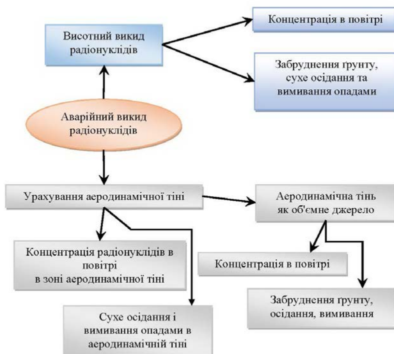
Рис. 5.1. Блок-схема організації розрахунків характеристик забруднення повітря і ґрунту при аварійному викиді.
