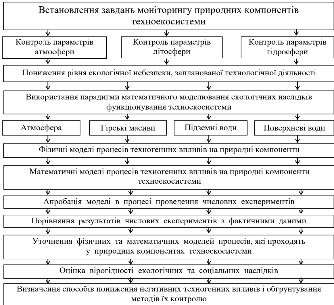
Рис. 2.6. Схема отримання результатів моніторингу природних компонентів техноекосистеми
