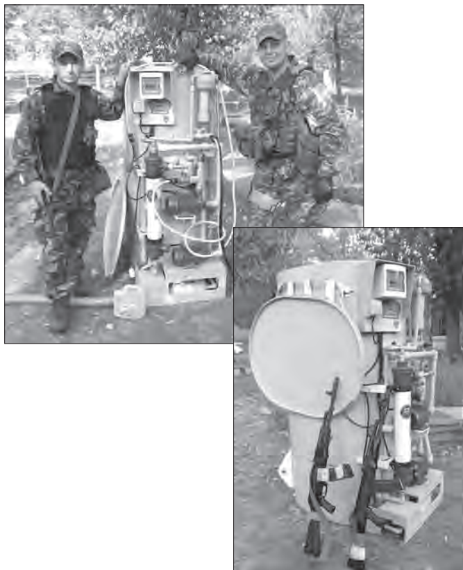
Фото 4.1. Загальний вигляд блок-елемента мобільної фільтрувальної установки (розробка на базі патентів України за участю ДЕА) для отримання питної води та води для госпіталів в польових умовах
