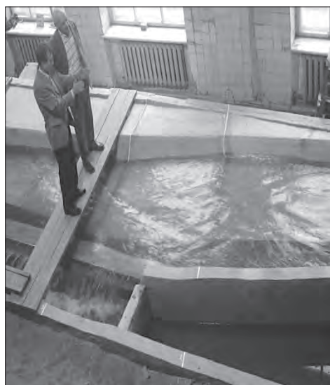
Фото 6.5. Лабораторні дослідження протипаводкової акумулюючої ємкості «Тершаків» на р. Бистриця у Львівській області
