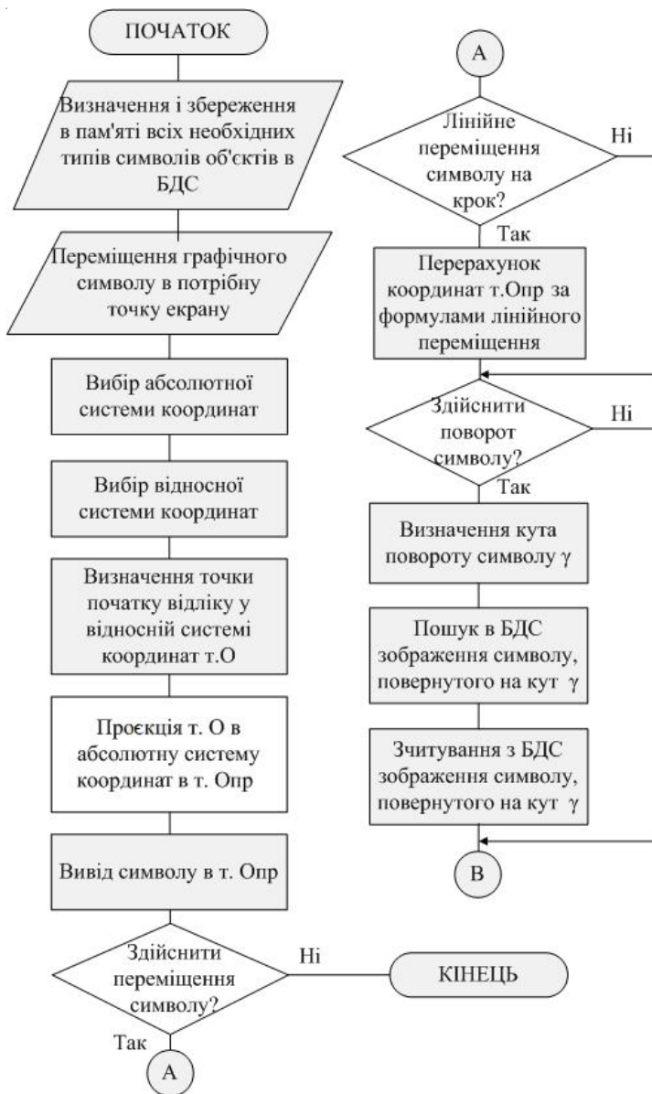
Рис. 2.3. Модифікований алгоритм повороту складного картографічного умовного позначення, який реалізує метод базових матриць (т.О – точка об'єкта; т. Опр – точка об'єкта проєктна) [26]
