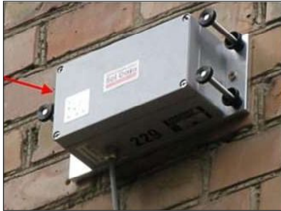
Рис. 2.18. Тривісний геофон акусто-сейсмічного моніторингу системи «Горгона», встановлений по проспекту Перемоги в м. Києві, що виконує вимірювання рівня вібрацій і шуму внаслідок будівельних робіт
