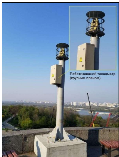
Рис. 1. Статичний пункт роботизованої тахеометрії «Парк Слави», м. Київ (світлина Шевченка Р.Ю., 2019 р.)
