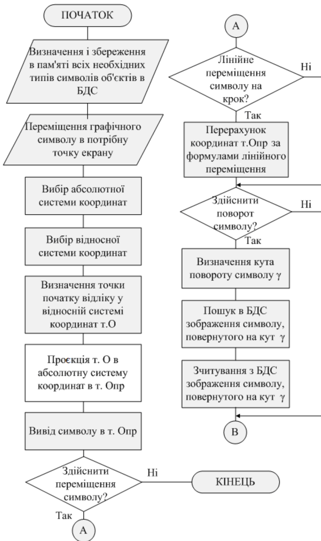
Рис. 2.4. Модифікований алгоритм повороту складного картографічного умовного позначення, який реалізує метод базових матриць (т.О – точка об'єкта; т. Опр – точка об'єкта проектна) [26]
