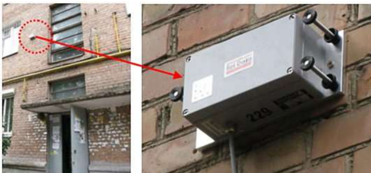
Рис. 2.20. Тривісний геофон акусто-сейсмічного моніторинга системи «Горгона», встановлений по проспекту Перемоги в м. Києві, щовиконує вимірювання рівня вібрацій і шуму внаслідок будівельних робіт
