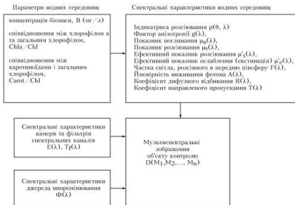
Рисунок 4 – Загальна схема розв'язку прямої задачі формування мультиспектральних зображень водного середовища з фітопланктоном та вищими водними рослинами
