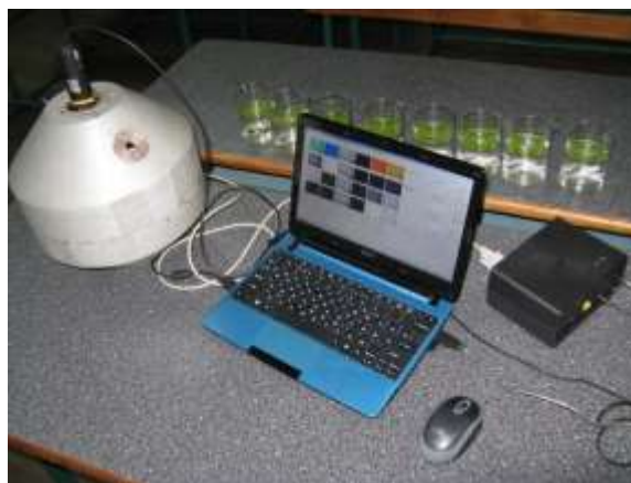
Рисунок 9 – Засіб мультиспектрального екологічного контролю забруднення водних середовищ за допомогою ряски малої ( Lemna minor L.): а) структурна схема засобу контролю, б) зовнішній вигляд дослідного зразка
