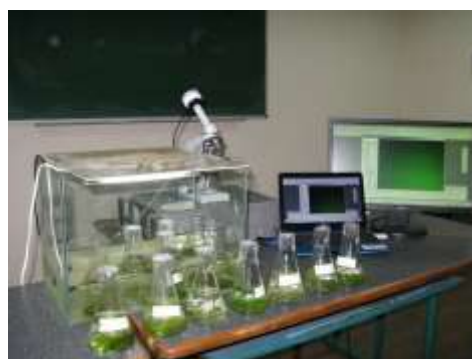
Рисунок 7 – Засіб мультиспектрального контролю екологічного стану водних об'єктів за параметрами фітопланктону: а) структурна схема засобу контролю, б) зовнішній вигляд дослідного зразка
