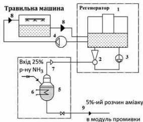
Рис. 10. Технологічна схема пристрою відновлення водного розчину: 1 – електролізер; 2 – ежектор; 3, 4 – насос; 5 – електричний нагрівач; 6 – електромагнітний клапан; 7 – вхідний розчин аміаку; 8, 9 – запірні вентилі.
