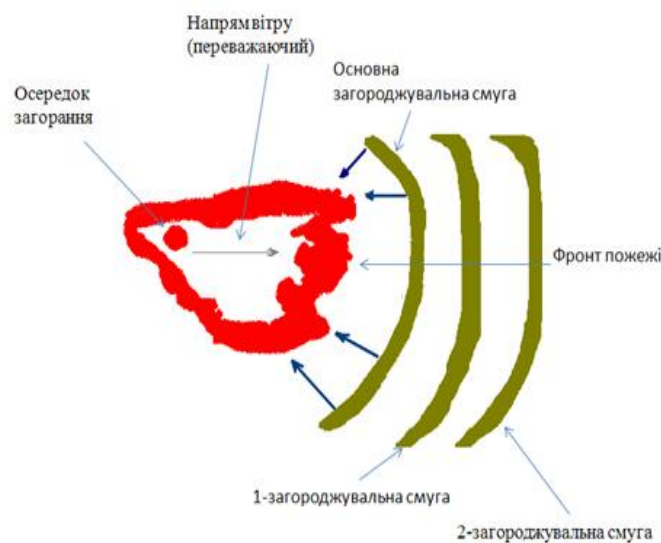
Рисунок 18 – Схема гасіння лісової пожежі з використанням солей ПГМГ
