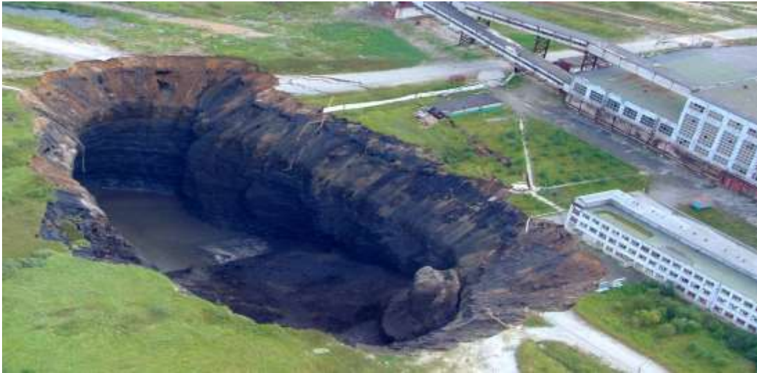
Рисунок 3.4 Провал на полі шахти «Свердловськантрацит» в 1976 р.
